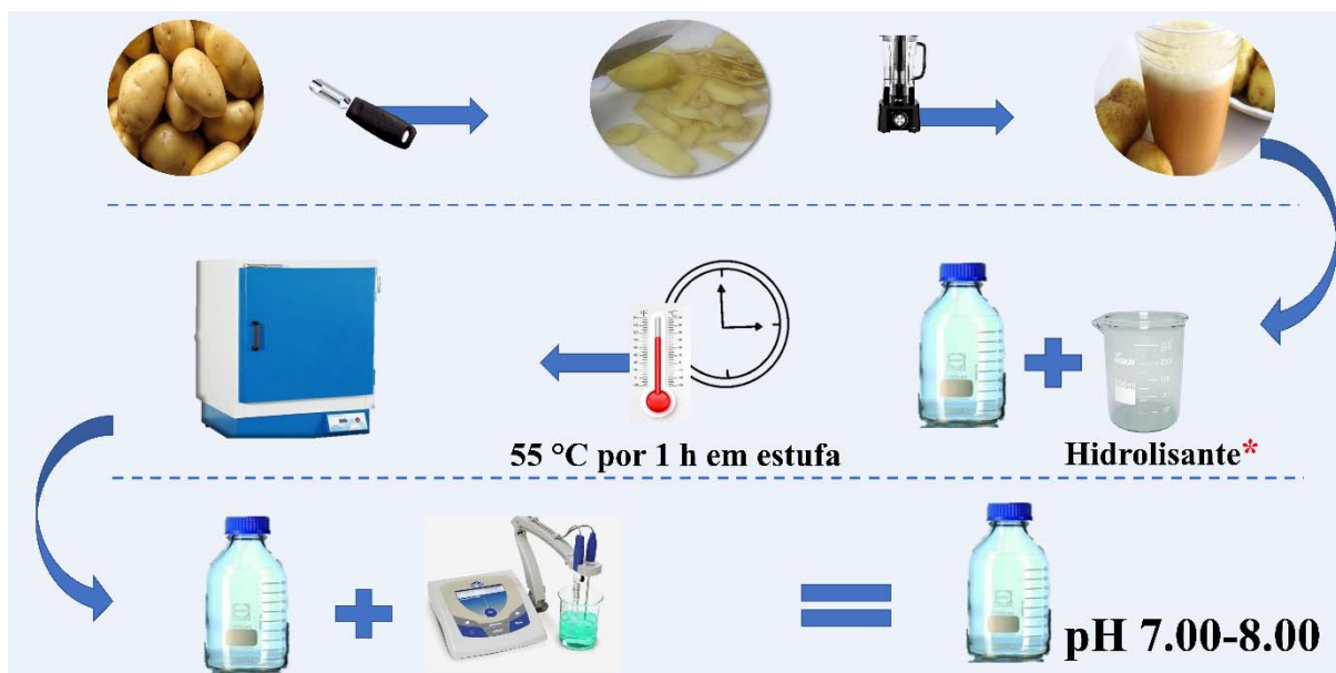
Figura 7 - Fluxograma da etapa de pré-tratamento físico-químico da casca de batata
