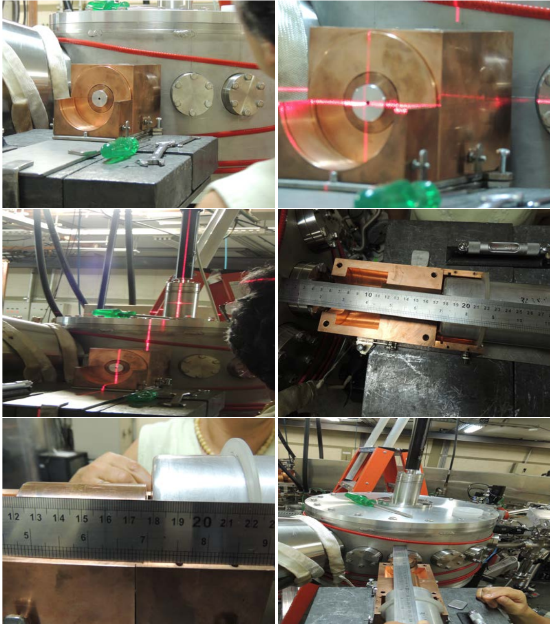
Figura 3.33: Imagens da montagem de um detector na posição de medida. As primeiras correspondem ao cubo de Cobre da blindagem interna, com o colimador central que tem inserido um tampão de Al. Em algumas se observam as linhas de laser para corroborar o correto posicionamento do colimador, e as medidas da distância da janela da câmara ao detector.
