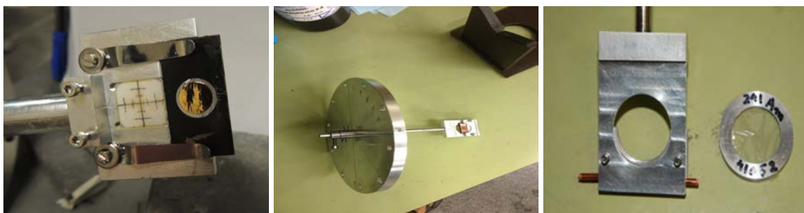
Figura 3.5: Imagens do suporte de alvos com um alvo de Au junto ao view screen , no centro o tampo da câmara antiga com o suporte de fontes de calibração e a direita detalhe do suporte de fontes em anel de Al e uma fonte com moldura desse material.
