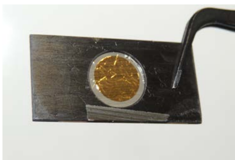
Figura 3.30: Imagem de um alvo de Au em moldura de fibra de C.
