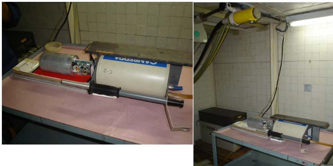
Figura 3.13: Imagens do posicionamento do detetor e fonte de raios-x do IPEN.
