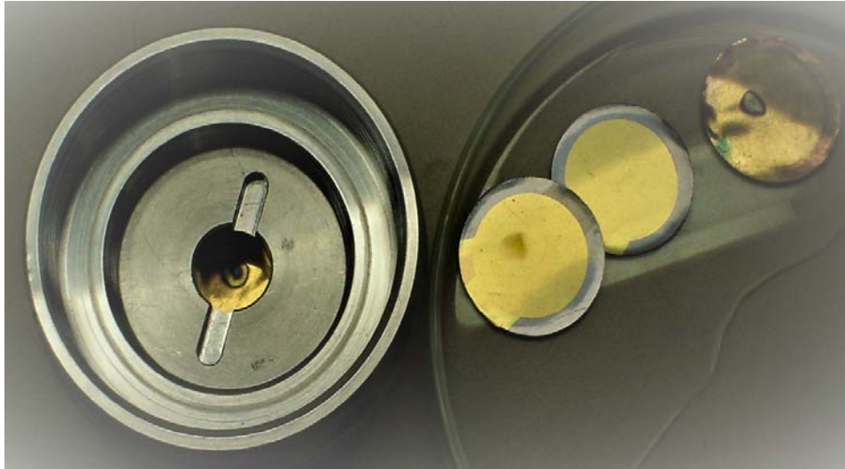
Figura 3.32: Alvos de \text{CaF}_2 no suporte de irradiação e irradiados. Pode-se ver que os que foram irradiados apresentam uma mancha escura no lugar onde o feixe de prótons bateu.
