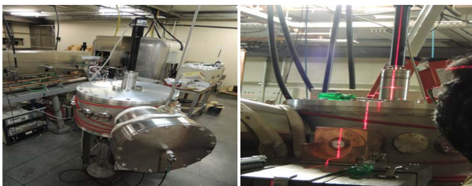
Figura 3.3: Câmara de irradiação da nova linha de 10 – 100 keV. Na imagem da esquerda, se destacam a faraday cup e o acionador da torre de alvos, na imagem da direita, um suporte/blindagem de cobre sendo alinhado com laser.
