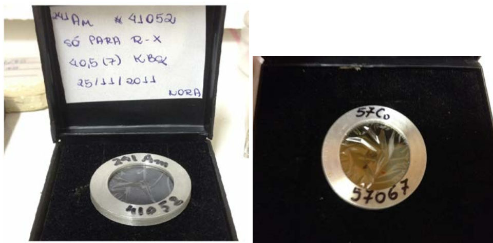
Figura 3.24: Imagens das fontes de ^{241}\text{Am} e ^{57}\text{Co} confeccionadas entre duas folhas de Mylar fixadas por um aro de Al sobre um anel do mesmo material.
