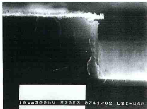
FIGURA 3.19 Foto obtida em um Microscópio Eletrônico de Varredura. Estrutura final obtida em um processo tripla camada , com pressão final de câmara de 30 mTorr, potência aplicada a bobina de 100 W e potência aplicada ao eletrodo de 60 W. Visualização da maior anisotropia das paredes das estruturas.
