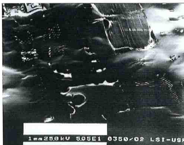
FIGURA 3.13 Foto obtida em um Microscópio Eletrônico de Varredura. Formação de bolhas e o “levantamento” da camada de alumínio devido a formação de bolhas (eliminação do solvente contido na camada de resiste espesso). Lâmina depositada com rotação do spinner de 1000 rpm e 105° C de temperatura final de cura.
