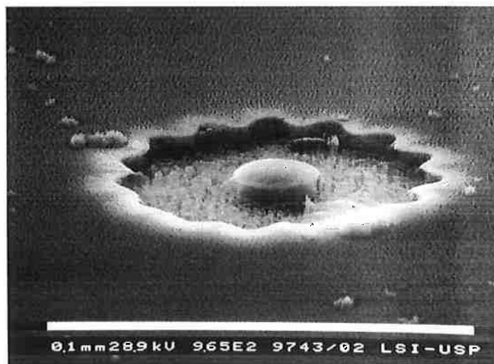
Figura 3.20 Foto obtida em um Microscópio Eletrônico de Varredura. Estrutura final obtida em um processo tripla camada empregando litografia por feixe de elétrons.
