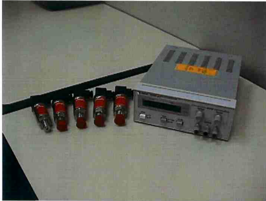
Figura 3.4. Transdutores de pressão e respectiva fonte de alimentação.
