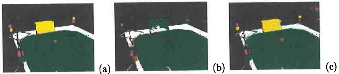
Resultados do uso de MLPs: (a) RGB; (b) HSV e (c) YUV.
