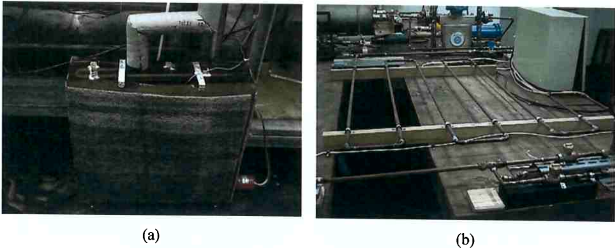
Figura 4.5. Sistema de controle do grau de sub-resfriamento.
