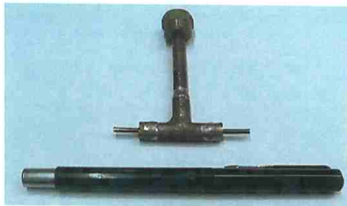
Figura 4.6. Exemplo da montagem das tomadas de pressão da seção de testes.
