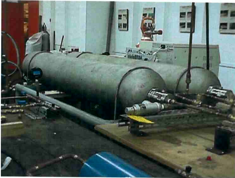
Figura 4.4. Novos reservatórios de alta pressão (capacidade individual 100 litros).
