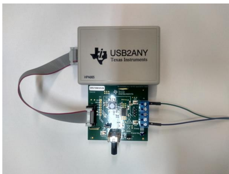
Figura 4.6 - Foto do controlador do motor brushless de 3 fases e da placa mestra.
