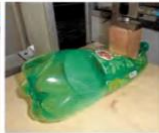
Figura 10 - Garrafa PET verde, após ensaio de compressão estática
