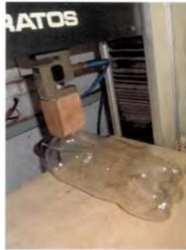
Figura 7 - Montagem do ensaio de compressão das garrafas
