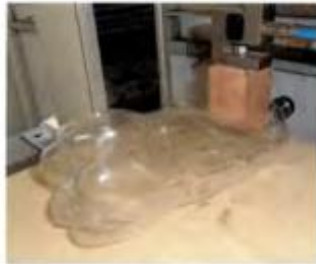
Figura 9 - Garrafa PET incolor, após ensaio de compressão estática
