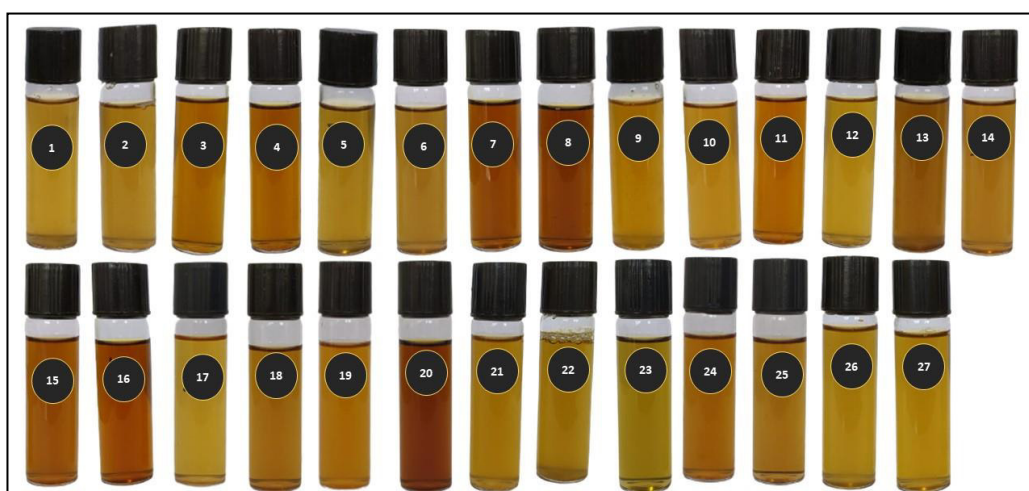
Figura 13. Coloração do hidrolisado hemicelulósico da mistura de bagaço e palha de cana (1:1).
