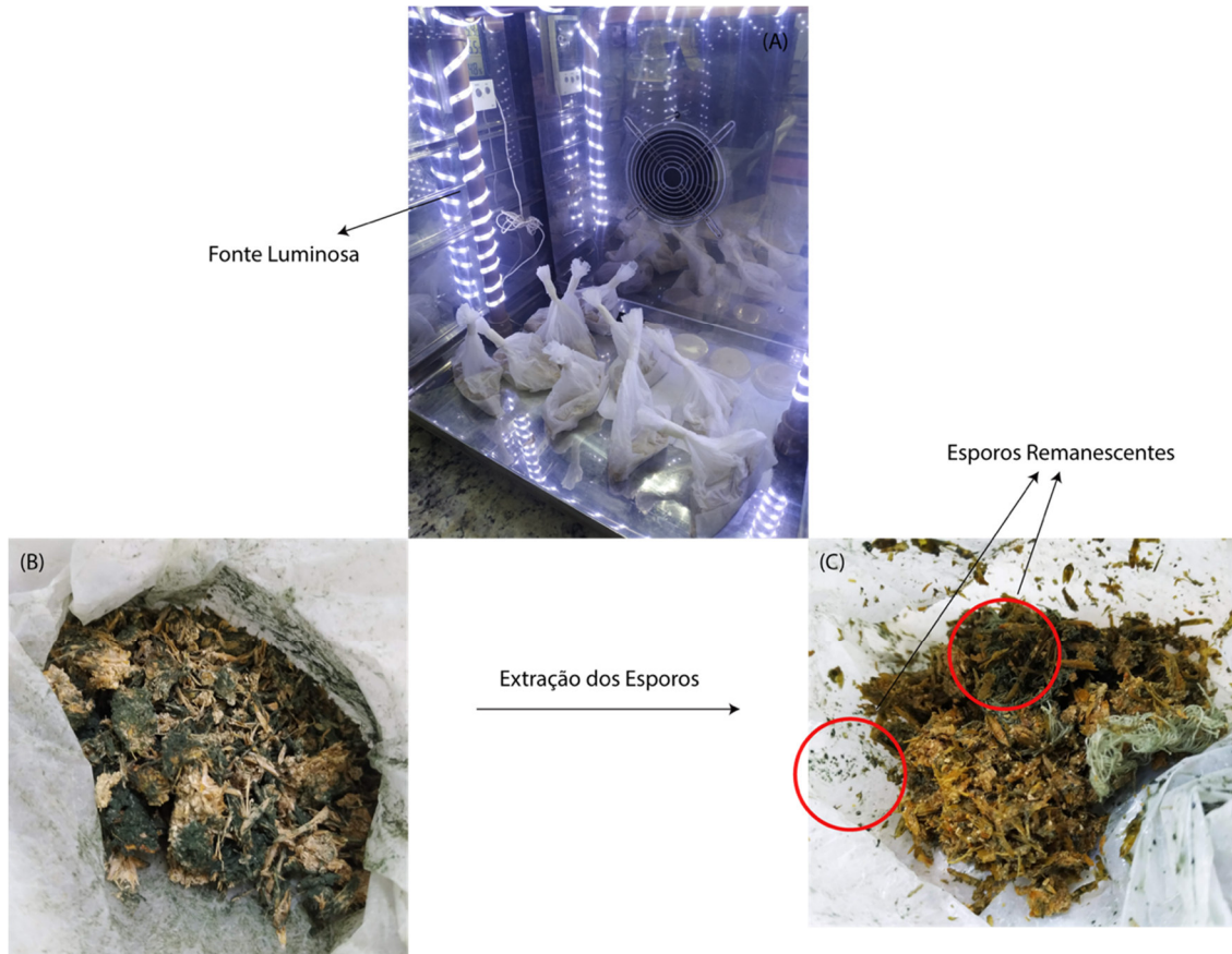
Figura 31. Etapas no processo de FES pelo T. harzianum conduzida em embalagens plásticas autoclaváveis de Polietileno de alta densidade. (A) Estufa microbiológica + Luzes LED; (B) Meio de cultivo fermentado e pigmentado em verde; (C) Meio de cultivo após a extração dos esporos com uma solução salina de 0,9 % (m/m) NaCl e 0,1 % (v/v) Tween 80.
