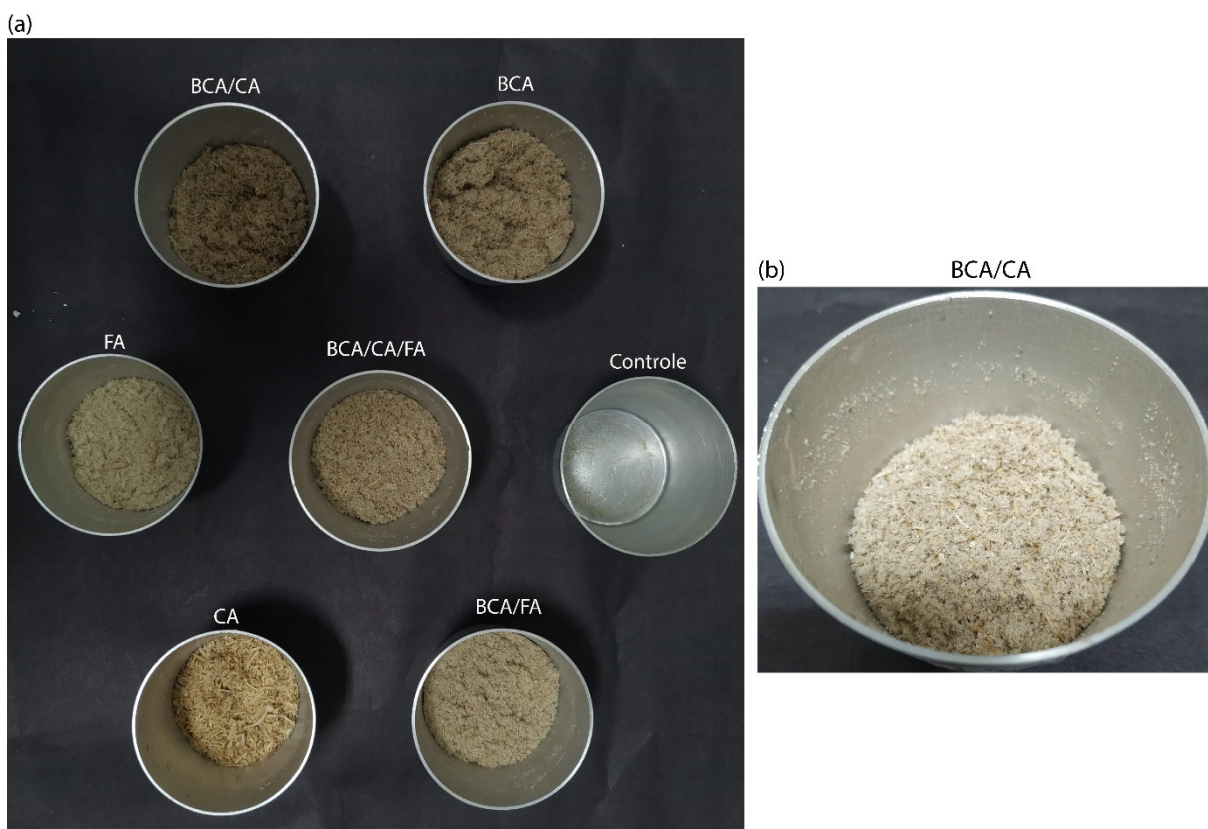
Figura 25. Diferentes adjuvantes de secagem utilizados no processo de formulação dos SLs em estado sólido. (a) Diferentes combinações de subprodutos agrícolas utilizados como adjuvantes de secagem no processo de liofilização de uma solução de SLs a uma concentração de 2,7 g/L, onde BCA: bagaço de cana-de-açúcar; CA: casca de arroz; FA: farelo de arroz. (b) Ilustração em perspectiva aumentada da combinação BCA/CA. O controle foi formulado a partir da secagem da soução de SLs sem a utilização dos adjuvantes.
