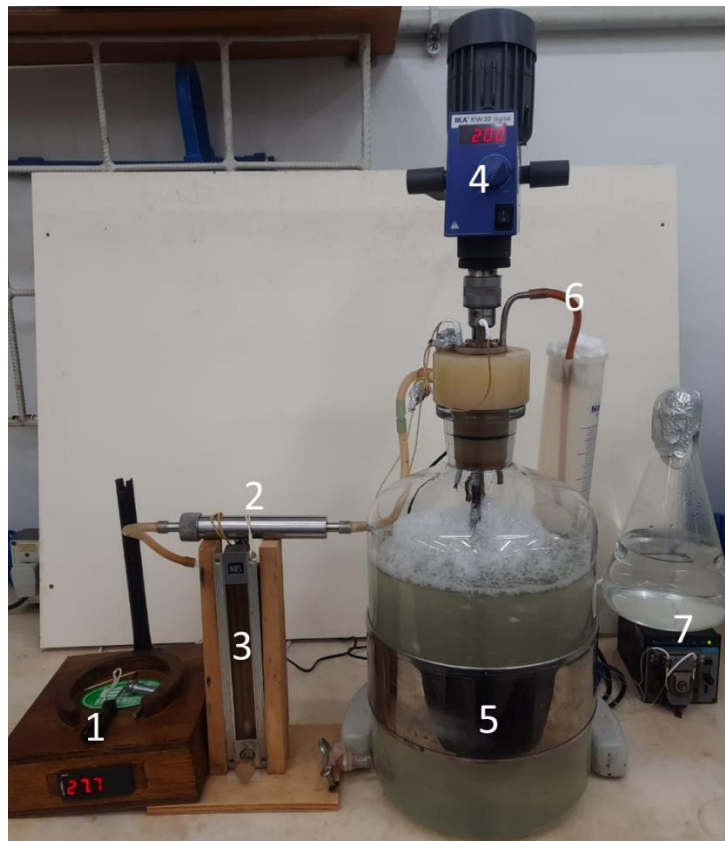
Figura 5. Biorreator de bancada de baixo cisalhamento de 14 L. Controlador de temperatura e camisa de aquecimento (1 e 5), filtro de ar (2), rotâmetro para controlar a vazão de ar (3), motor do impelidor (4), saída de ar (6) e bomba peristáltica para reposição de água de evaporação (7).
