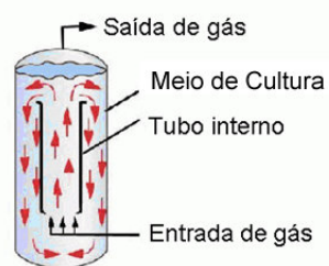
Figura 8 - Air-lift de cilindros concêntricos, onde a injeção de ar ocorre na base do biorreator
