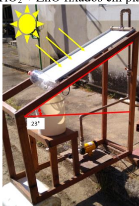
Figura 27 – Esquema do reator solar com TiO_2 + ZnO fixados em placa.
