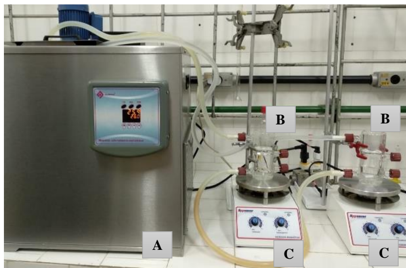
Figura 4.3 – Aparato experimental para o ELL.
