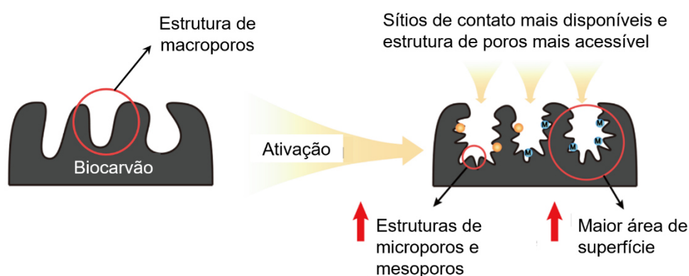
Figura 11 - Mecanismo de ativação de BC: aumento de estrutura de poros e área superficial.
