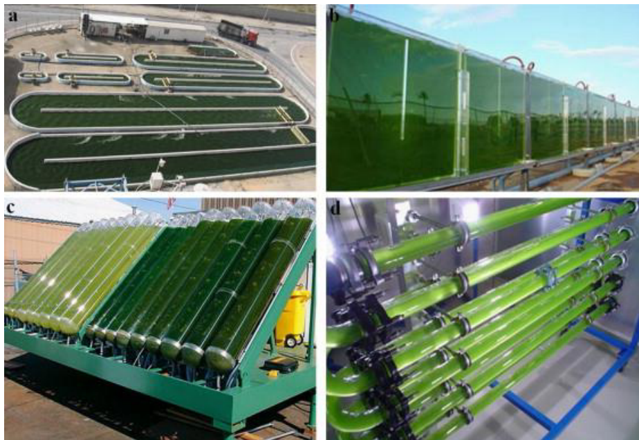
Figura 3 - Principais fotobiorreatores para cultivo de microalgas em larga escala: (a) raceway, (b) placas planas, (c) coluna de bolhas e (d) tubular.
