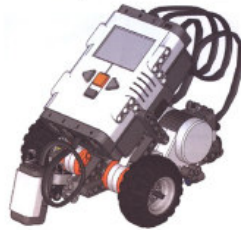
Figura 7 – Robô seguidor de linha preta montado com LEGO Mindstorm NXT para atividade de desafio prático durante preparação ao torneio Amigos da Robótica.
