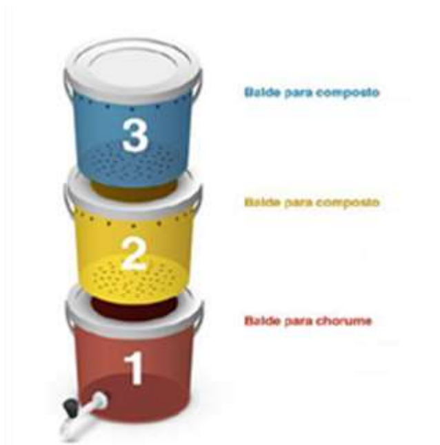
Figura 8 - Montagem de Composteira
