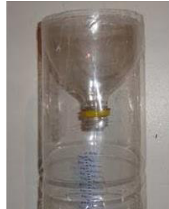
Figura 6: pluviômetro caseiro montado com garrafa pet
