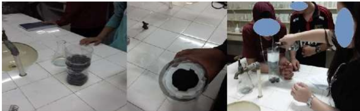
Figura 11 – Adequação do filtro de água confeccionado com garrafa PET com carvão ativado para redução do cloro livre presente na água
