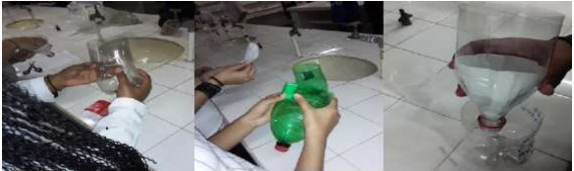
Figura 9 – Construção do filtro de água com garrafa PET
