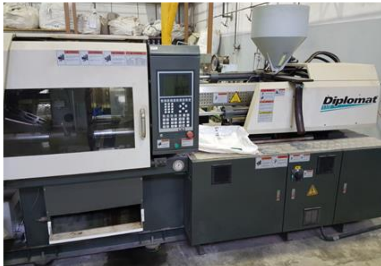
Figura 8- Injetora de termoplásticos utilizada para confecção de corpos de prova.
