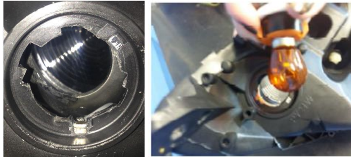
Figura 7 – Fotos da carcaça do farol dianteiro com derretimento do PP.
