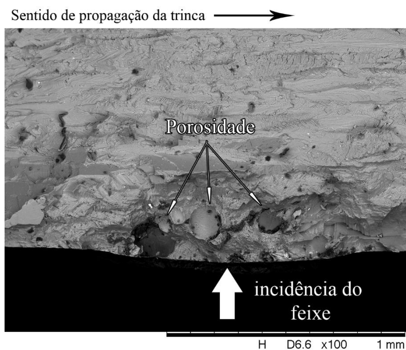
Figura 110 - Fractografia obtida via MEV do corpo de prova da liga 2198-T851 na condição L01, ensaiado sob fadiga com R = 0,1 e F_{max} = 1,1 kN, para um tamanho de trinca de 22,5 mm, mostrando a primeira linha de aquecimento, com a presença de fusão (Ampliação de 100x).
