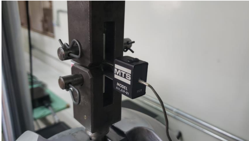
Figura 57 - Medidor de deslocamento MTS mod. 632.03F-21 fixado em um corpo de prova da liga 2198, de modo a monitorar o tamanho da trinca pelo método compliance
