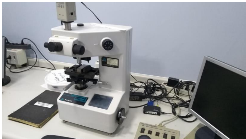
Figura 48 - Microdurômetro BUEHLER modelo MICROMET 2004
