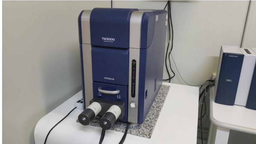
Figura 58 - Microscópio eletrônico de varredura de bancada HITACHI modelo TM3000
