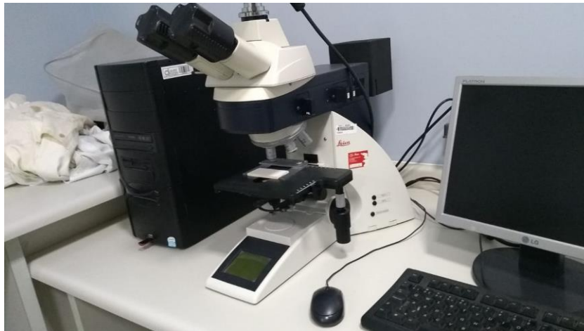
Figura 47 - Microscópio óptico LEICA modelo DM4000 M
