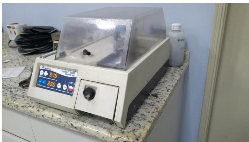
Figura 46 - Cortadora de precisão BUEHLER modelo IsoMet 1000
