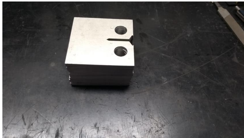
Figura 52 - Corpos-de-prova do tipo C(T) usinados por eletroerosão
