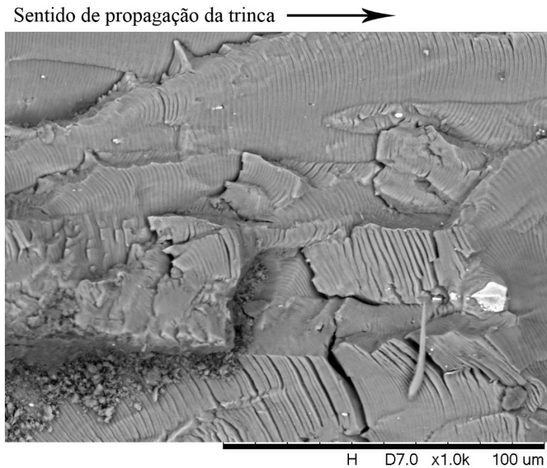
Figura 106 - Fractografia obtida via MEV do corpo de prova da liga 2198-T851 na condição L01, ensaiado sob fadiga com R = 0,1 e F_{max} = 1,1 kN, para um tamanho de trinca de 31,75 mm. (Ampliação de 1000x).
