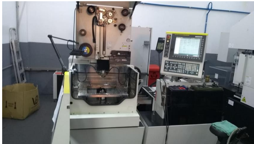
Figura 51 - Máquina de eletroerosão FANUC modelo ROBOCUT DiO- \alpha
