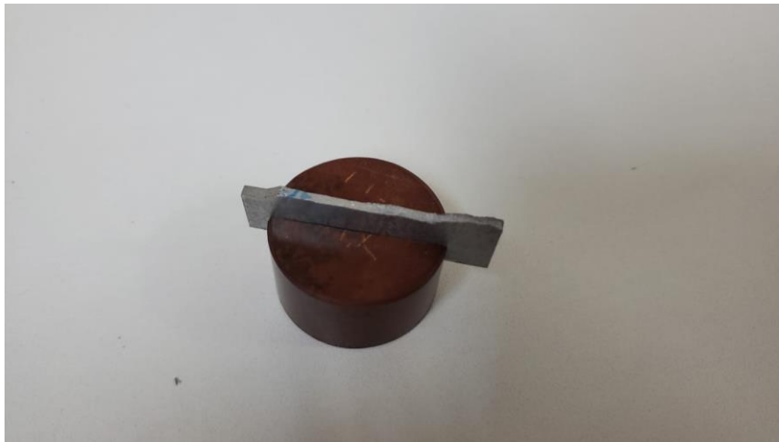
Figura 59 - CDP da liga 2198-T851 fraturado por fadiga fixado em um porta amostras de baquelite
