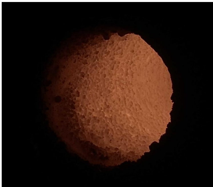
Figura 22 - Foto da parte interna do tubo após o vazamento com incrustação no interior do tubo.
