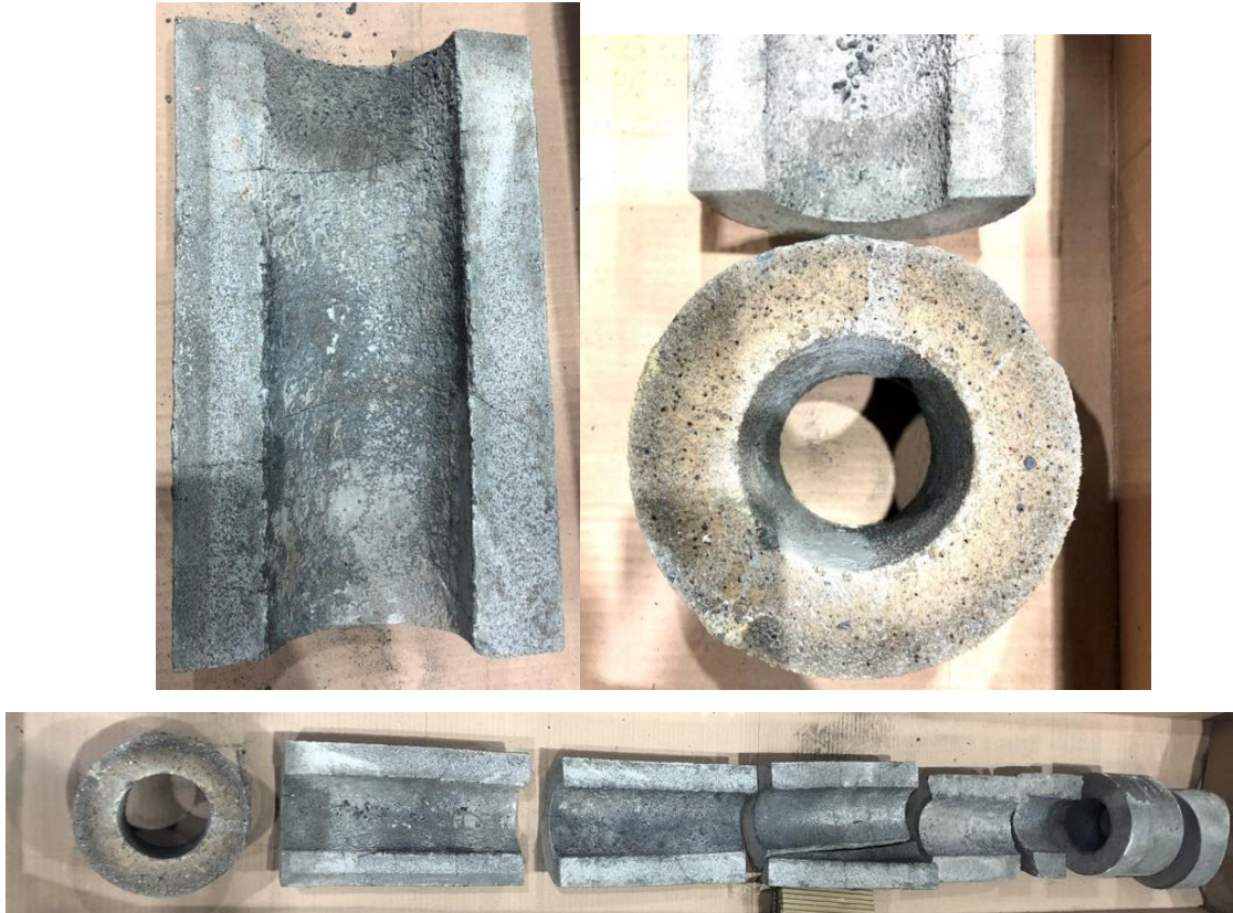
Figura 20 - Foto apresentada da vista interna do tubo de vazamento após o uso, tubo sem incrustação.
