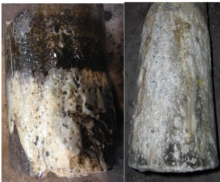
Figura 23 - Parte externa do tubo atacada pela escória.
