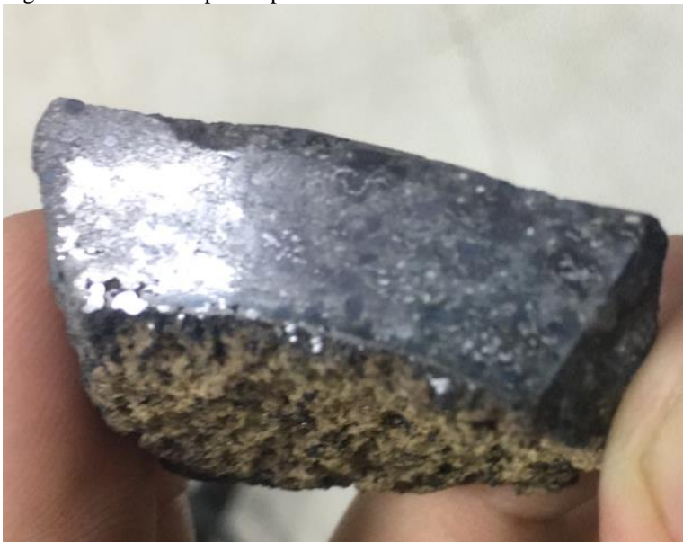
Figura 19 - Amostra polida para análise no MEV.
