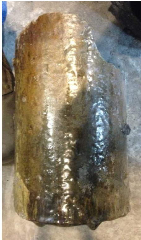
Figura 24 - Parte externa do tubo refratário em condições normais de processo.
