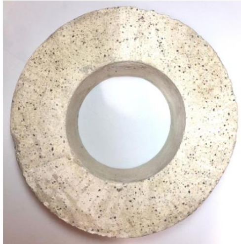
Figura 16 - Foto do tubo antes do uso com diâmetro inicial medido de 88,2 mm, dentro do range de trabalho de 87,5 a 89 mm.
