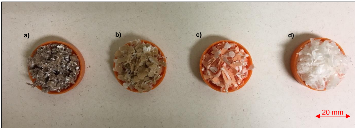
Figura 27 – Resíduos poliméricos após separação da celulose e moagem: a) CAGE; b) CABC; c) CABR e d) CAT.
