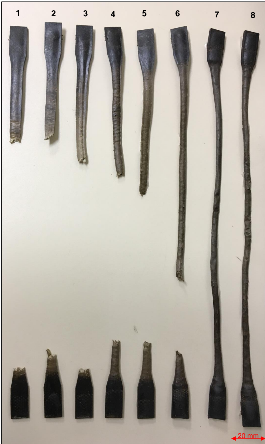
Figura 37: Imagem dos corpos de prova do resíduo CABE após ensaio de tração.
