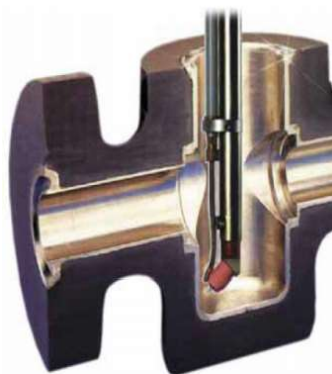
Figura 2 - Processo de revestimento de uma válvula por soldagem TIG.
