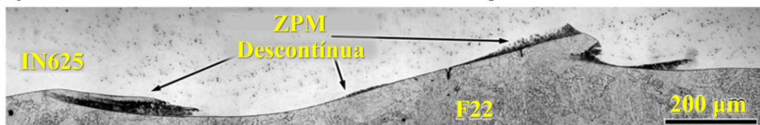
Figura 12 - Microestrutura da interface entre F22 e Inconel 625 após tratamento térmico de 10h.
