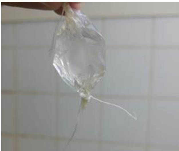
Figura 14 - Membrana de diálise lacrada com fio de nylon.
