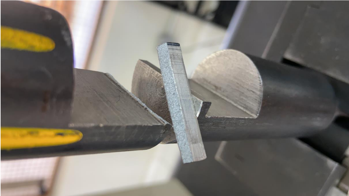
Figura 73 – Dispositivo de ensaio fraturado após ensaio de K_{IV} .
