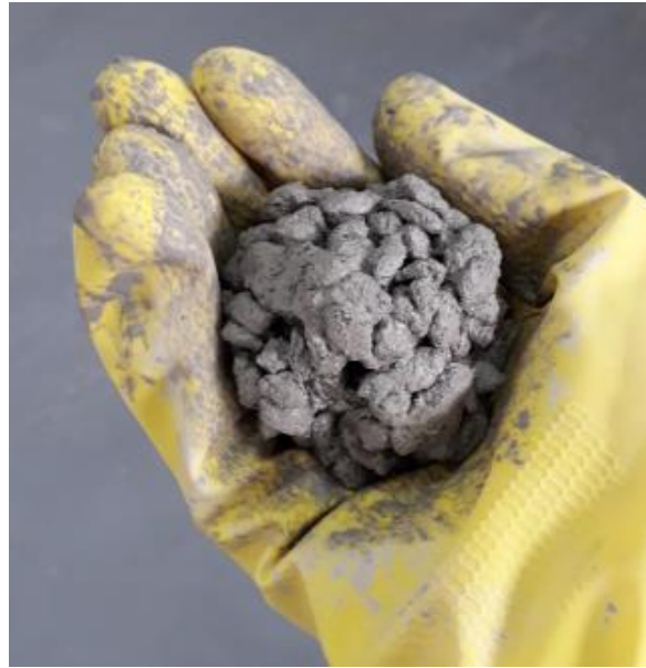
Figura 21 – Moldagem da esfera de concreto permeável, traço M2-c, para uma condição de relação a/c ótima.
