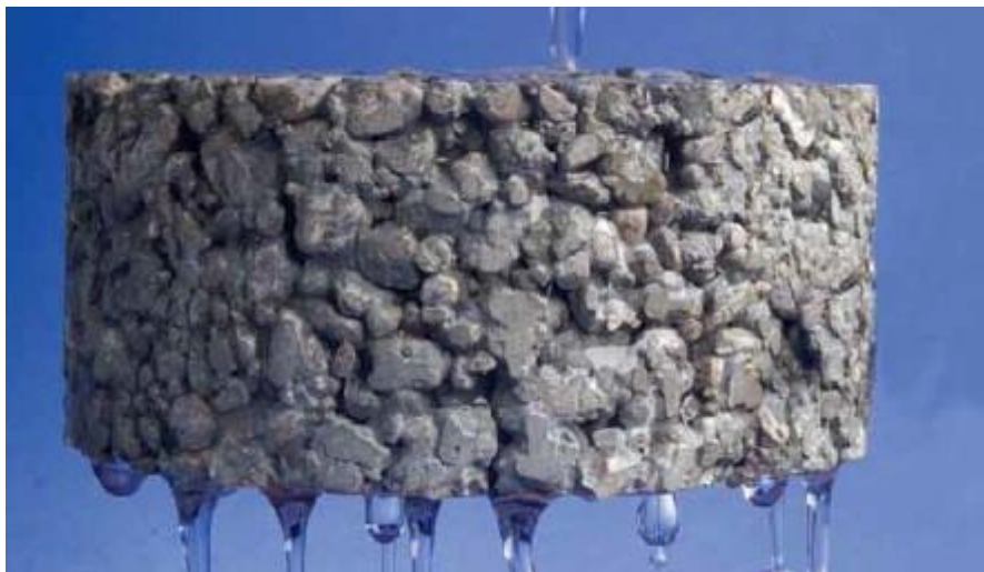
Figura 5 – Amostra de concreto permeável
