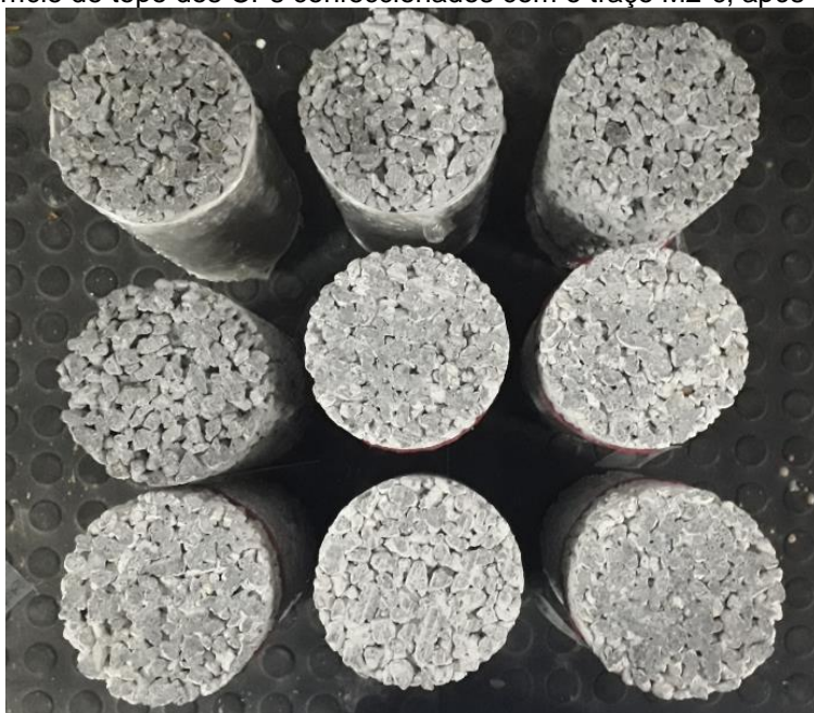
Figura 23 – Superfície de topo dos CPs confeccionados com o traço M2-c, após retificação
