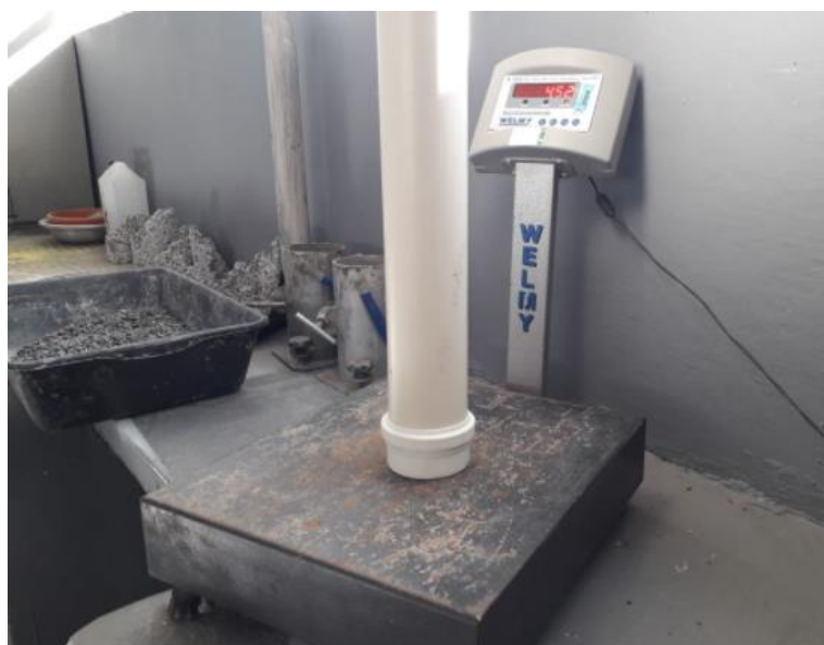
Figura 25 – Soquete de Adensamento de CPs de Concreto Permeável
