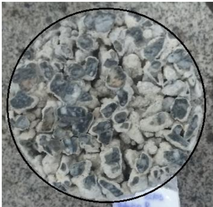
Figura 18 – Corpo de Prova com tratamento de superfície por retificação
