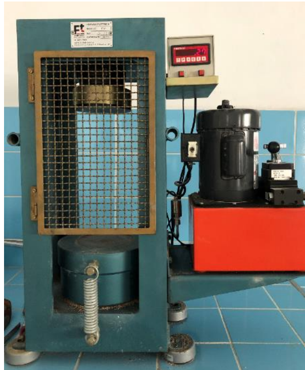
Figura 15 – Prensa elétrica utilizado nos ensaios de resistência à compressão dos CPs
