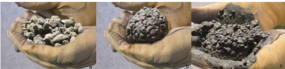
Figura 11 – Avaliação da relação água/cimento em função da consistência, (a) com relação a/c baixo, (b) com relação a/c ótimo e (c) com relação a/c alto.
