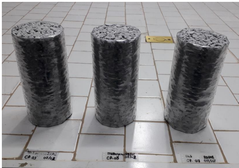
Figura 24 – Superfície lateral dos CPs revestida por filme plástico
