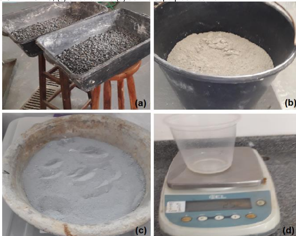
Figura 20 – Matérias-primas constituintes do Concreto Permeável (a) agregado graúdo, (b) cimento CP-III-40-RS, (c) sílica ativa e (d) aditivo superplastificante.
