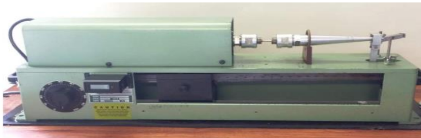
Figura 19 - Equipamento utilizado nos ensaios de fadiga por flexão rotativa. Fatigue Dynamics, modelo RBF-200.
