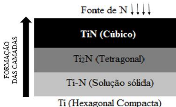
Figura 4 - Ilustração esquemática do processo geral de nitretação.
