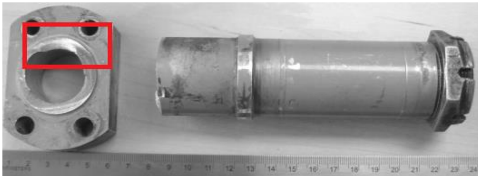
Figura 9- Eixo fraturado do trem de pouso da aeronave.
