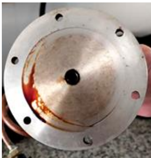
Figura 14 - Imagem de um dos flanges do forno com resíduo condensável de pirólise
