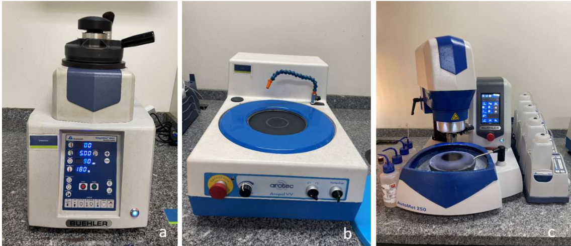
Figura 32 – a) Embutidora utilizada. b) Lixadeira manual. c) Politriz automática.
