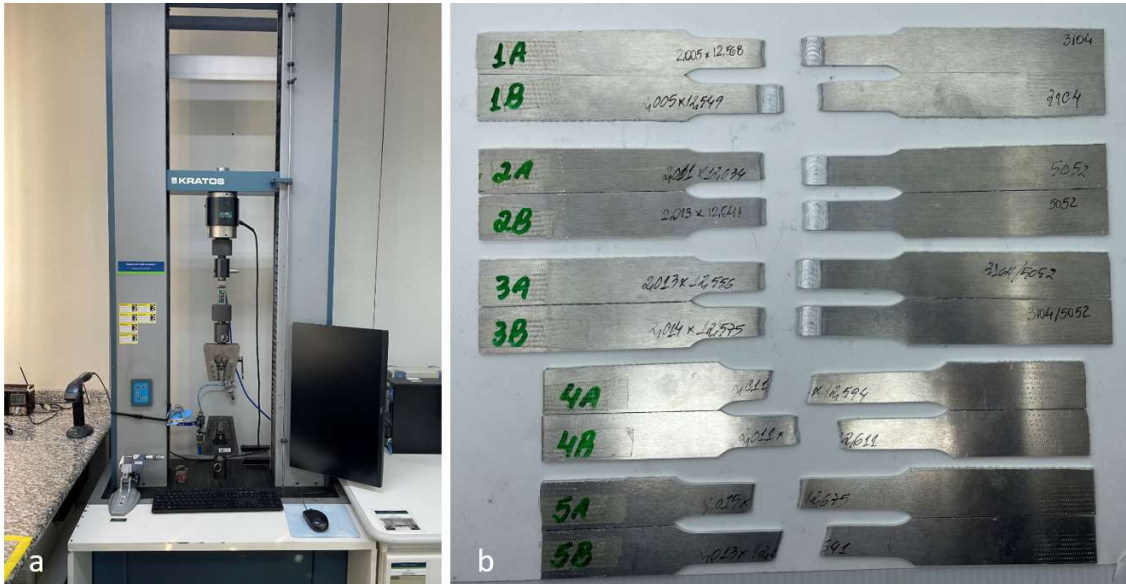
Figura 34 – a) Equipamento para ensaio de tração. b) CP's após ensaios de tração.
