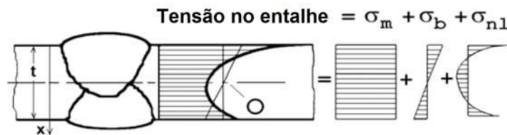
Figura 9 – Componentes de tensão em uma chapa soldada.
