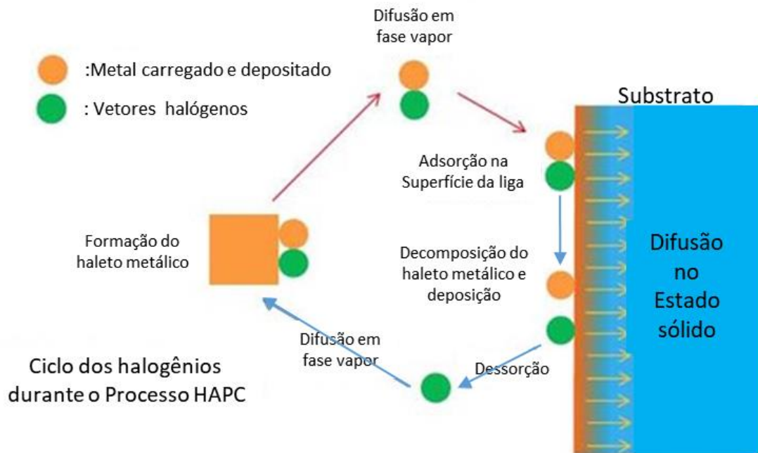
Figura 16 – Representação esquemática do Processo Halide Active Pack Cementation
