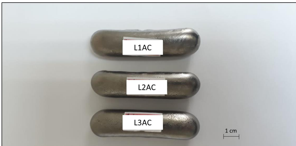
Figura 23 - Lingotes \gamma -TiAl fundidos em um forno a arco
