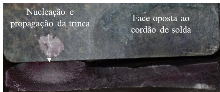
Figura 65 – Região de nucleação e propagação de trinca para CDP de metal soldado sem ponto, ensaiado na tensão máxima de 460 MPa
