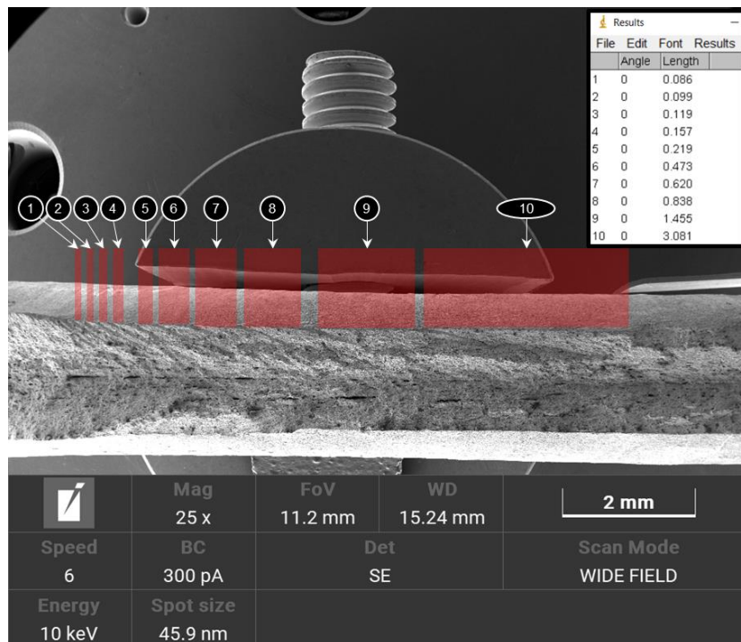
Figura 112 – Fratura final com presença de marcas oriundas dos últimos ciclos de fadiga
