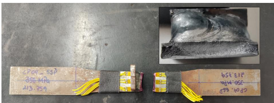
Figura 101 – Fratura do CDP soldado sem ponto de solda
