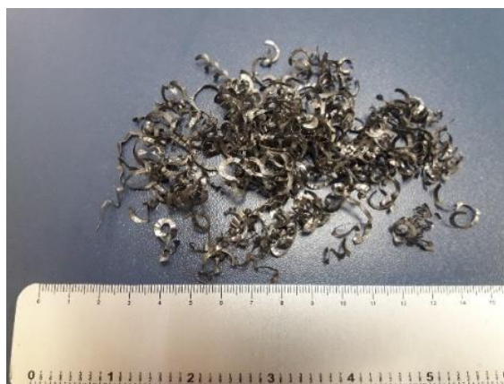
Figura 16 – Imagens de câmera fotográfica dos cavacos com 0,2 mm de espessura obtidos após a usinagem do tarugo cilíndrico.
