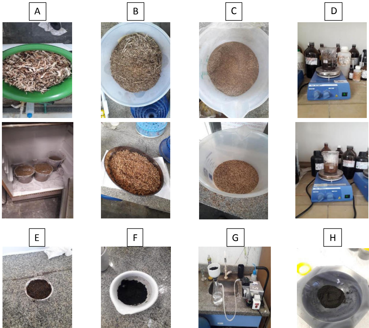
Figura 2 - Sequência das etapas de ativação do bagaço de cana-de-açúcar e borra de cerveja. A) resíduos em repouso em água por 24 h; B) pedaços cortados até tamanho aproximado de 0,5 cm; C) resíduos triturados até obtenção de um fino pó; D) solução com o resíduo e H_3PO_4 por 3 dias em agitação E) material impregnado com H_3PO_4 após secagem em estufa; F) carbono obtido após calcinação G) etapa de lavagem do carbono com água ultrapura H) carbono ativado.
