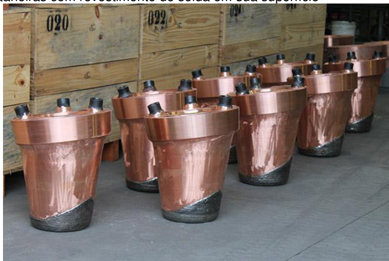
Figura 4 - Ventaneiras com revestimento de solda em sua superfície
