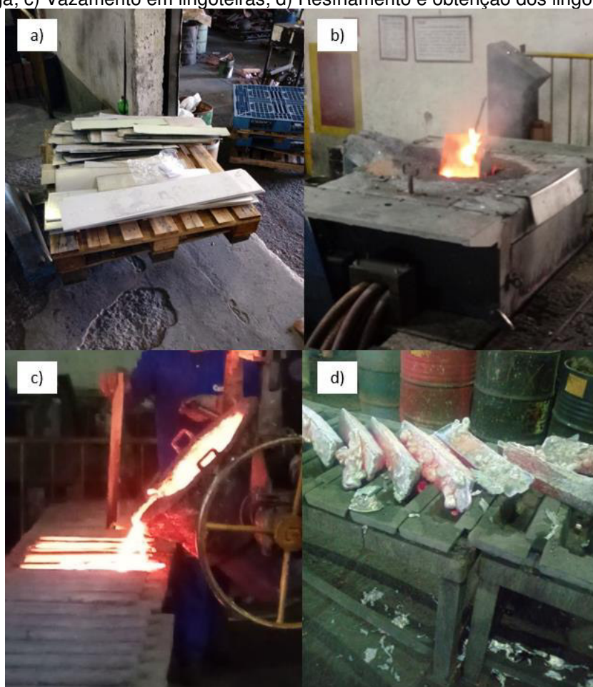
Figura 10 - Processo de produção da liga doadora de Fe-Al: a) Separação da matéria prima; b) Fusão da liga; c) Vazamento em lingoteiras; d) Resfriamento e obtenção dos lingotes
