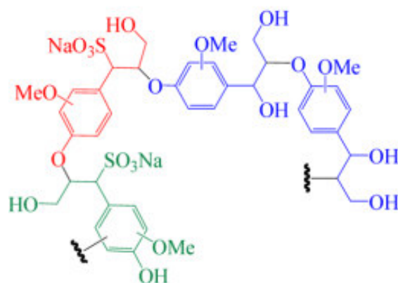
Figura 7 – Modelo de estrutura genérica do lignosulfonato de sódio.
