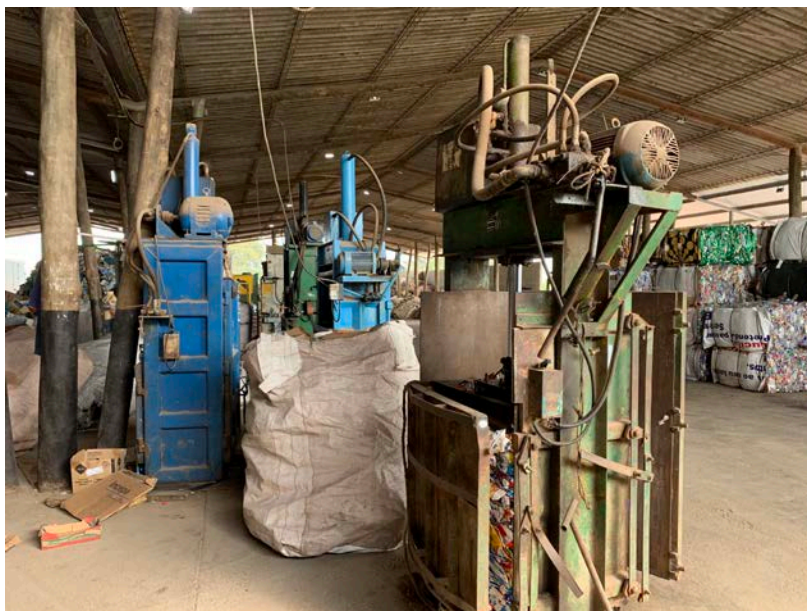
Figura 30. Máquina de prensagem/compactação de materiais recicláveis Fonte: Autora
