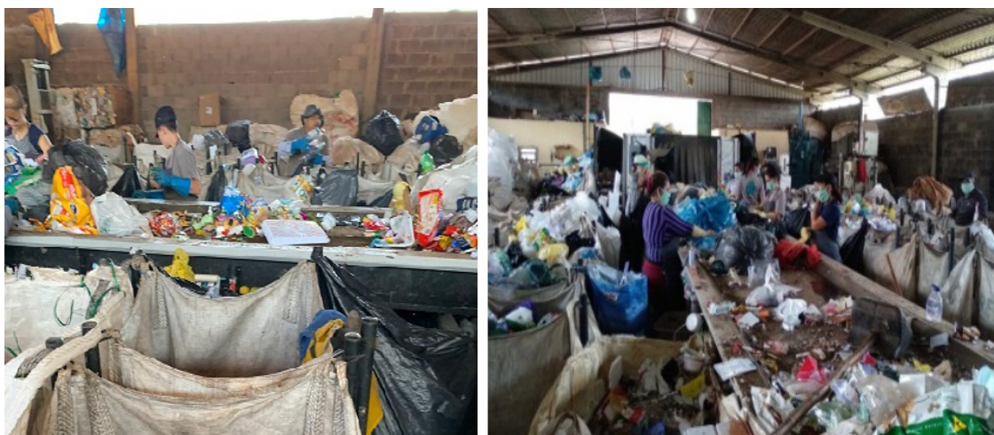
Figura 85. Esteira de triagem dos resíduos recicláveis Fonte: Autora
