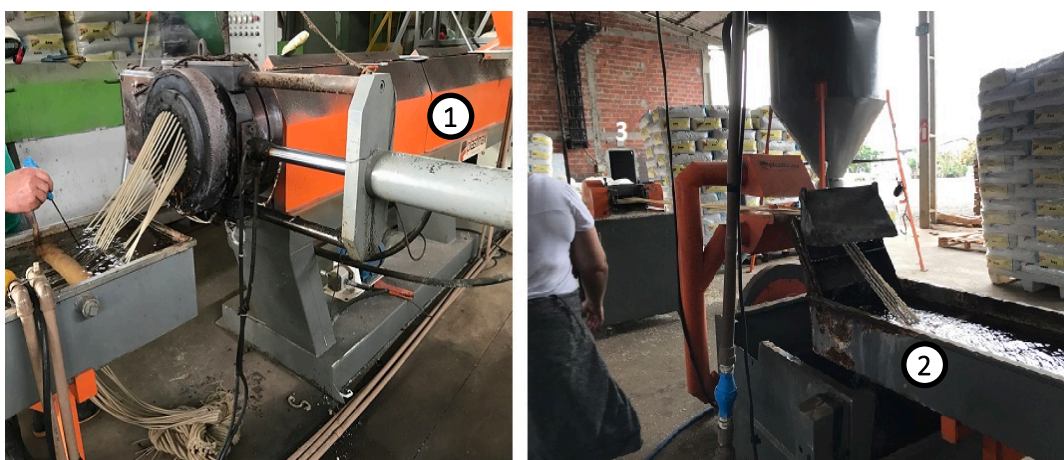
Figura 93. Processo de extrusão dos materiais plásticos de PEBD Fonte: Autora
