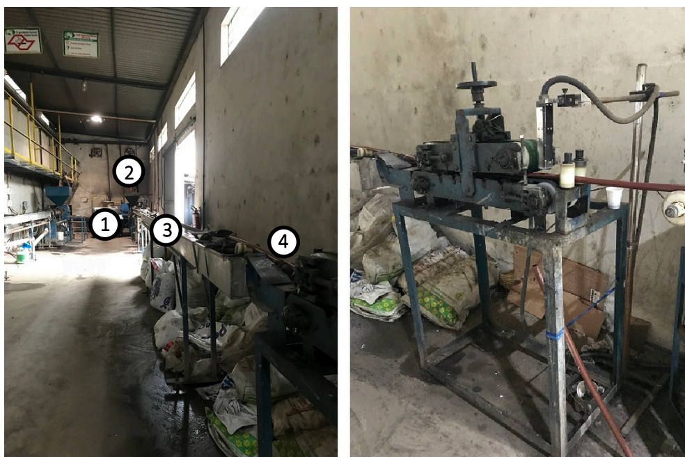
Figura 78. Processo de extrusão para fabricação de mangueira lisa Fonte: Autora
