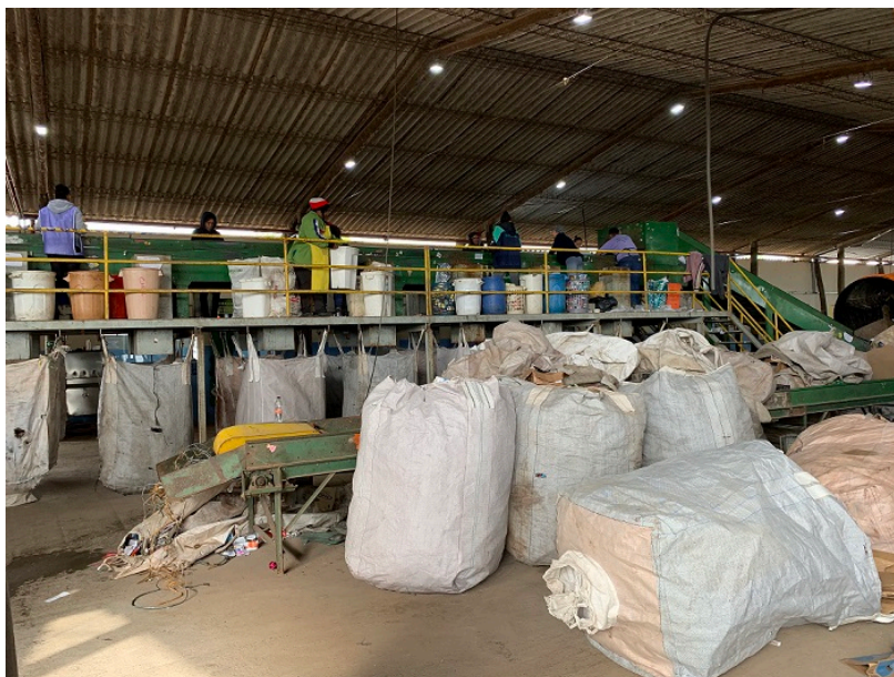
Figura 28. Esteira de triagem dos resíduos recicláveis Fonte: Autora
