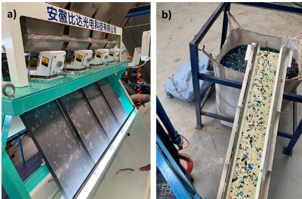
Figura 60. a) Máquina separadora de cor; b) Esteira de direcionamento Fonte: Autora
