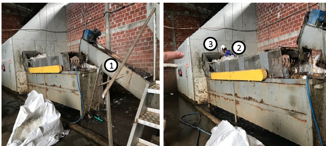
Figura 91. Reciclagem mecânica dos resíduos plásticos domiciliares de PEBD pós-coleta seletiva Fonte: Autora
