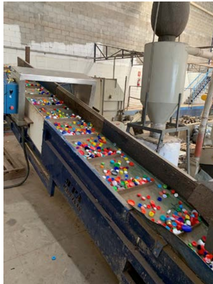
Figura 54. Resíduos plásticos PP após triagem de rejeitos industriais e início do processo de reciclagem Fonte: Autora
