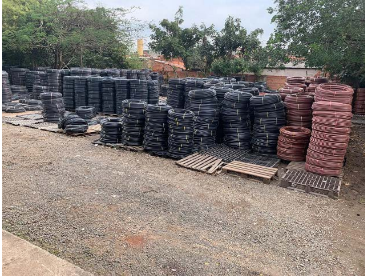
Figura 79. Estoque de mangueira lisa proveniente de material plástico de PEBD reciclado Fonte: Autora
