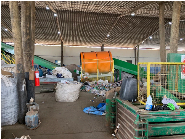
Figura 27. Início da esteira de triagem e rasga-saco Fonte: Autora
