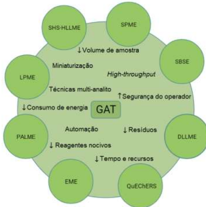
Figura 6. Resumo dos princípios da GAT e técnicas que atendem alguns deles. Os conceitos da GAT estão dispostos no centro enquanto técnicas que atendem alguns destes princípios de sustentabilidade estão dispostas nos círculos ao redor. SPME: microextração em fase sólida; SBSE: extração sortiva em barra de agitação; DLLME: microextração líquido-líquido dispersiva; QuEChERS: Quick, Easy, Cheap, Effective, Rugged and Safe ; EME: extração por eletromembrana; PALME: extração paralela em membranas artificiais líquidas ; LPME: microextração em fase líquida; SHS-HLLME: microextração líquido-líquido homogênea com solventes de hidrofiliabilidade comutável.
