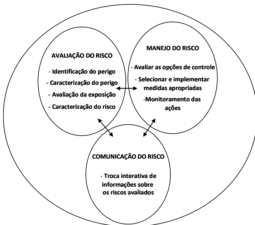
Figura 1 – Paradigma de análise de risco, enfatizando a separação funcional dos três componentes e a importância da interação entre eles. Fonte: BENFORD, 2001; INTERNATIONAL PROGRAMME ON CHEMICAL SAFETY, 2009a.
