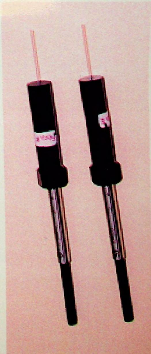
*Seringas adaptadas para Microextração em Fase Sólida (SPME)*
