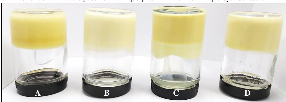
Figura 21 - Teste de inversão do frasco para demonstrar a formação da matriz tridimensional pela gelificação da formulação. Formulações a) 48,1, b) 48,2 c) 49 e d) 39 com Pluronic® F-127 micronizado. No fundo do frasco é possível notar que praticamente não há separação de fases.
