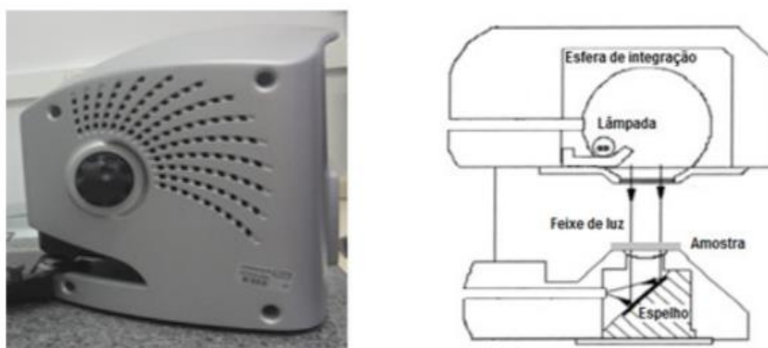
Figura 5. Desenho óptico do espectrofotômetro de refletância difusa com esfera de integração
