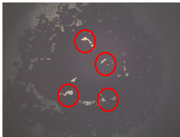
Figura 29- Imagens de MO da superfície de ECV contendo 3,0 mg/mL de NTC-F/dispersante, espaçamento em branco marcado pelo círculo vermelho, representa vazios na superfície do eletrodo.
