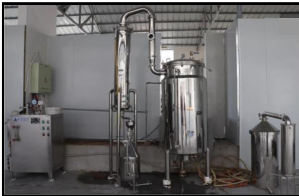
Figura 8. Extração do óleo essencial em escala industrial
