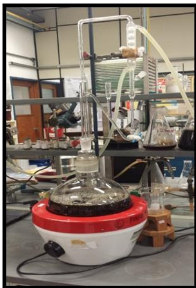
Figura 7. Extração do óleo essencial através do sistema de vidro tipo Clevenger
