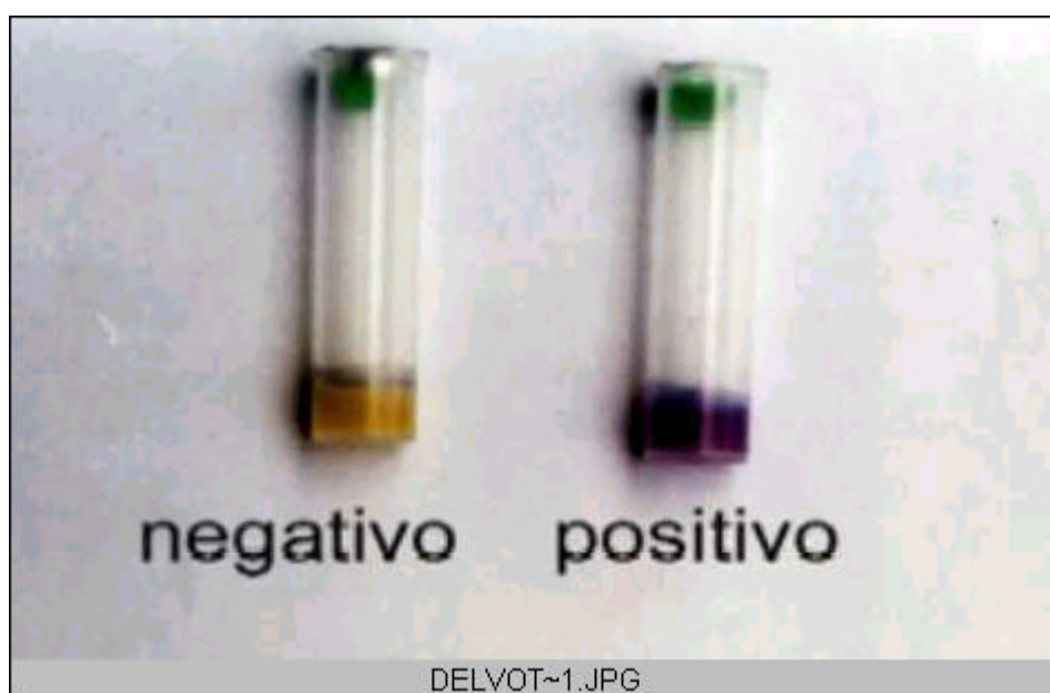
Figura 3: Resultados do teste microbiológico (Delvotest®), a coloração amarela significa um teste negativo para resíduo, enquanto a coloração púrpura é um teste positivo.
