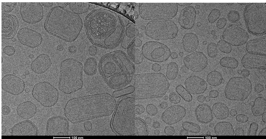
Figura 22. Criomicroscopia eletrônica de lipossomas de DMPC. Aumento de 62.000x. As barras indicam tamanho de 100 nm.
