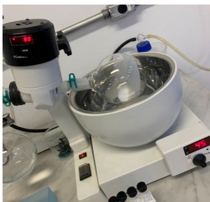
Figura 9 – Solução de fitantriol e F-127 sendo condensada no rotaevaporador.
