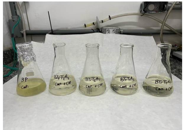
Figura 15. Amostras de meio BOLD 3N residual e meios BOLD 3N tratados em diferente temperaturas e aerações submetidos a tratamento com CAP seguido de centrifugação.
