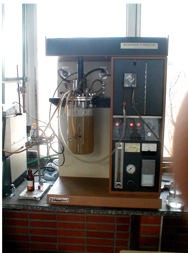
FIGURA 4.3: Foto do Fermentador de bancada tipo New Brunswick (mod. MF 105 – New Brunswick Sc. Co.).
