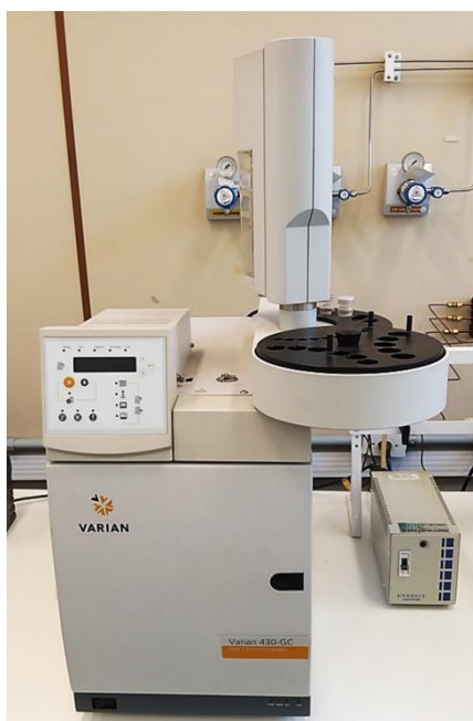
Figura 14 - Cromatógrafo a gás Varian GC, modelo 430 GC, utilizado na determinação da composição em ácidos graxos do óleo de soja.
