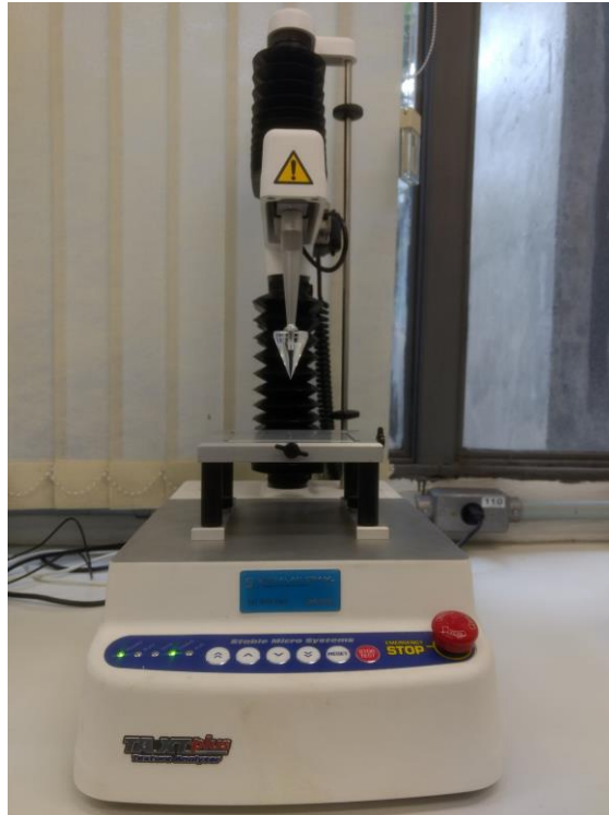
Figura 18 - Texturômetro TA.XT Plus com probe acrílico de formato cônico e ângulo de 45°, utilizado na determinação da consistência dos oleogéis.
